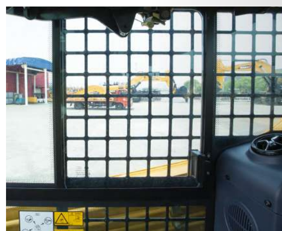
PLASĂ DE PROTECȚIE: Previne rănirea personalului cauzată de stropirea sau căderea pietrelor etc.
