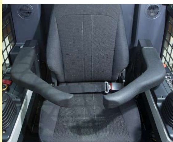
COTIERE DE SIGURANȚĂ: Cotierele de siguranță trebuie coborâte înainte de orice operațiune.
